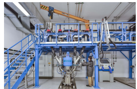
Der Präzisionskalandar links im Bild, rechts ist die 60-L Mischanlage zu sehen.
