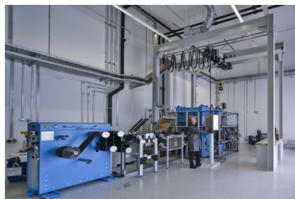
Der Präzisionskalandar links im Bild, rechts ist die 60-L Mischanlage zu sehen.
