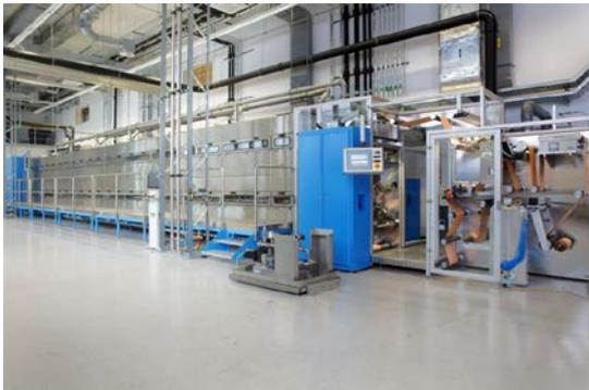
Beschichtungsanlage zur Elektroden-Fertigung am ZSW in Ulm.
