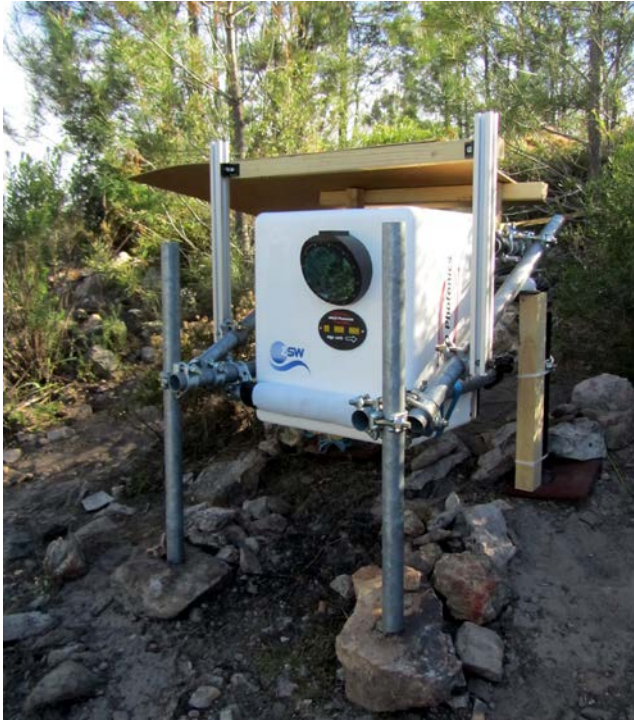
Das Lidar-System des ZSW am Rand des nordöstlichen Bergrückens beim Double-Hill Experiment in Perdigo, Portugal. Foto: ZSW
