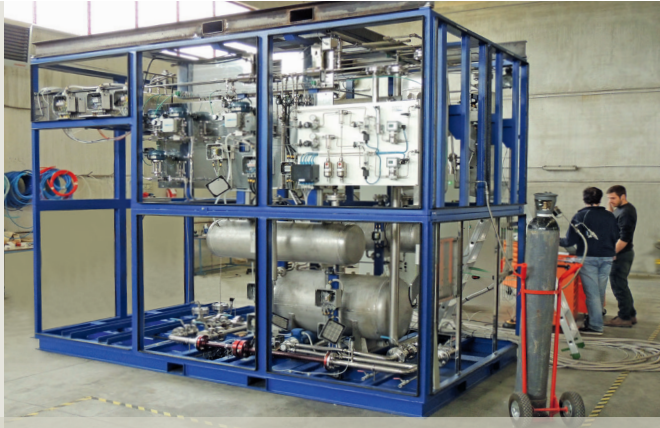
// Prüfstand für alkalische Druckelektrolyse-Blöcke
