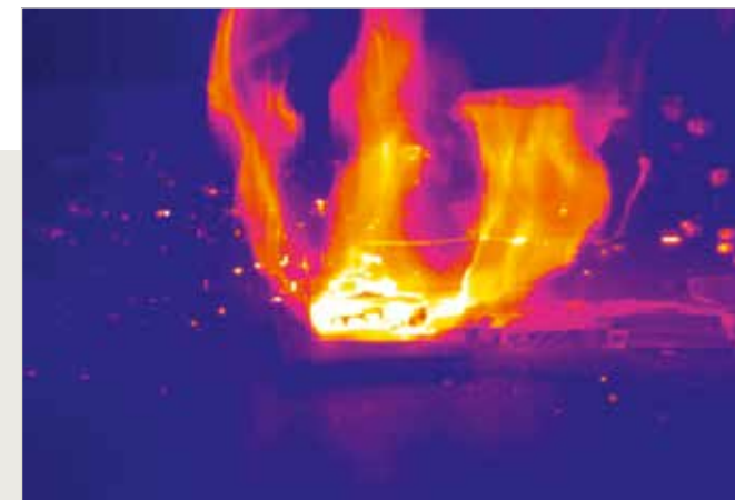
// IR-Aufnahme einer Lithium-Ionen-Zelle im Sicherheitstest. // IR imaging of a lithium-ion cell during the safety test.
