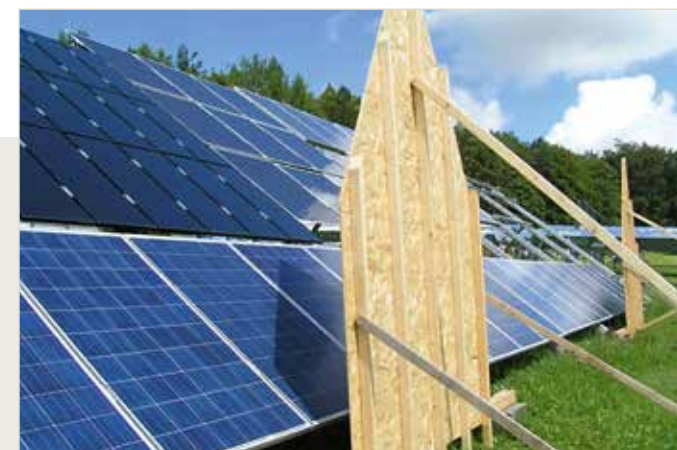
// Gleichförmige Beschattung des DUT- und des Referenzsystems mit Giebelschablonen. // Uniform shading of the DUT and reference systems using gable moulds.
