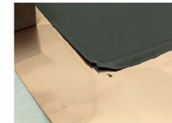
Herstellung von Li-SiO-C-haltigen Elektroden mit herkömmlichem Prozess.
