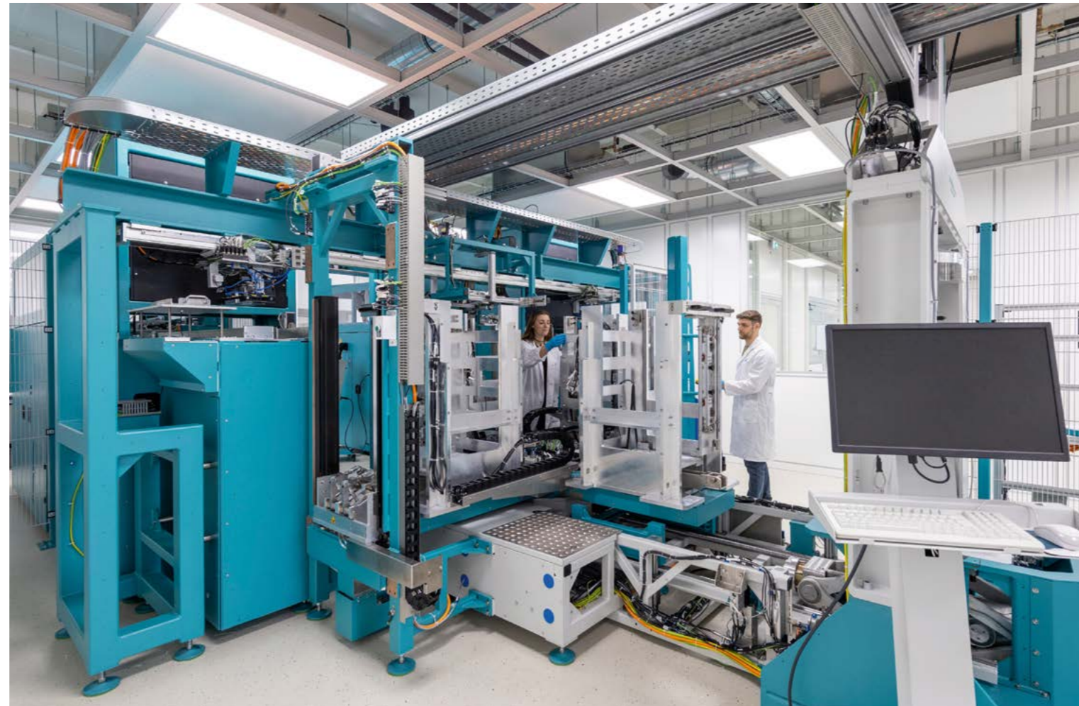
^ Für HyFaB entwickelte Anlage zur vollautomatisierten Stapelung von Brennstoffzellenstacks.
