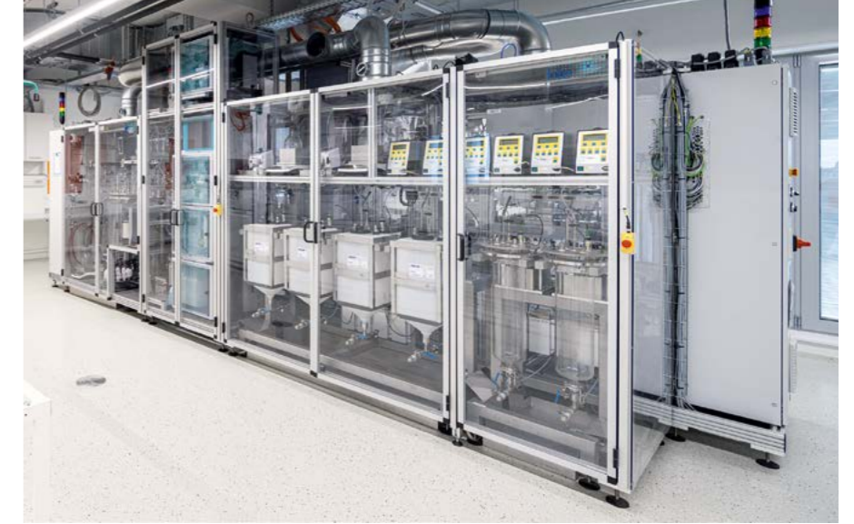
Fällanlage zur Herstellung von Aktivmaterialien für Natrium-Ionen-Batterien.
