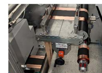
Herstellung von Li-SiO-C-haltigen Elektroden mit optimiertem Prozess.
