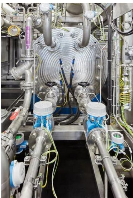
Prüfstand für die Erprobung von Elektrolysestacks bis 0,5 Megawatt.
