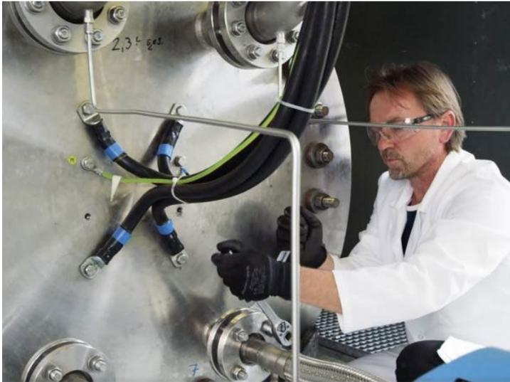
Einbau eines Elektrolysestacks im 100 Kilowatt Maßstab.
