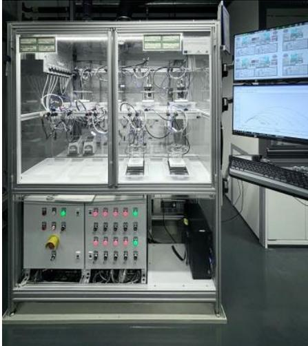
Mehrfachprüfstand für beschleunigte Alterungstests von Elektroden.
