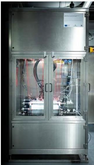
Prüfstand zur Erprobung von Elektroden und Katalysatoren.
