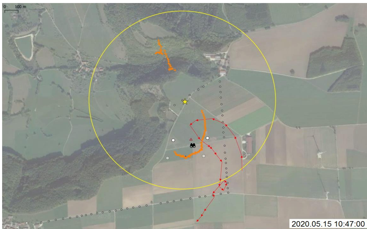
Abb. 31. Beispiel eines LRF-Flugwegs (rot), der vom IDF (orange) nicht detektiert worden ist. Das System war zeitgleich mit der Verfolgung eines anderen Vogels beschäftigt. Example of a LRF-track (red) which was not detected by IDF (orange). IDF was busy with tracking another bird.
