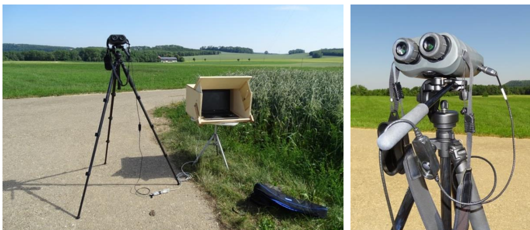
Abb. 11. Fotos des Laser-range finders mit Laptop, welcher sich in der Holzbox befindet (04.07.2019, J. Aschwanden). Foto of the laser-range finder together with the laptop which is in the wooden box.
