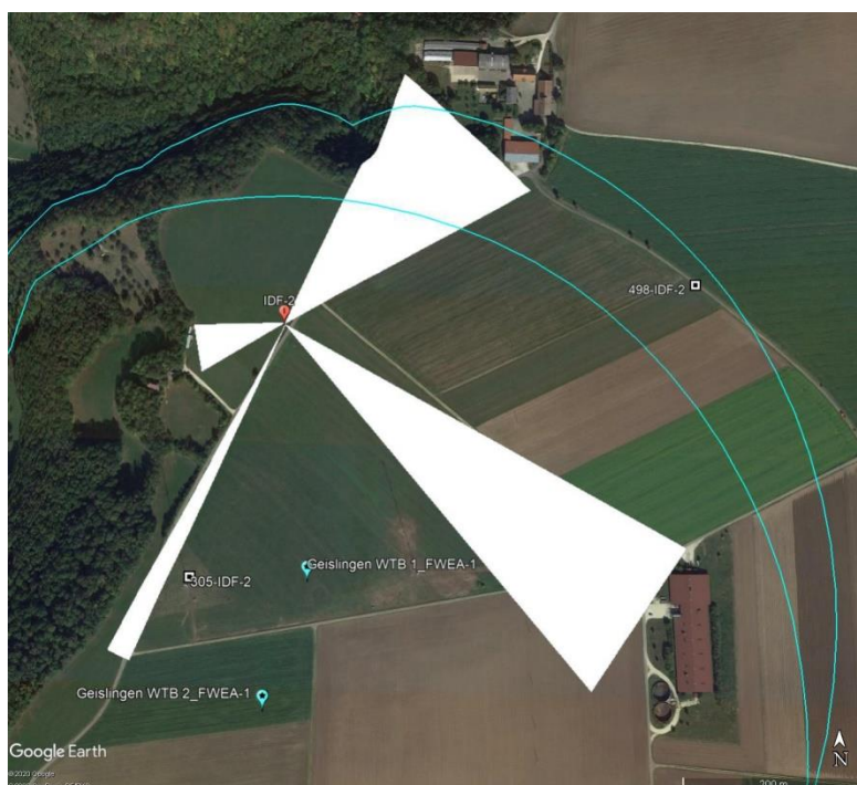
Abb. 10. Karte mit den Zonen (weisse Dreiecke) in denen maskierte Bereiche liegen (Gebäude, Straßen). Innerhalb dieser Zonen sind Flugbewegungen bis zur objektspezifischen Höhe ü.M. der maskierten Objekte für das IDF nicht detektierbar (Darstellung des Herstellers). Map of zones (white triangles) containing masked areas (buildings, streets). Flight movements up to the specific altitude above sea level of those masked objects are not detectable for IDF within these zones (illustration of the manufacturer).
