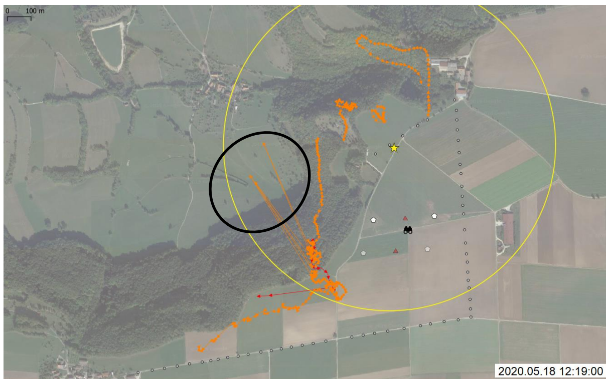
Abb. 30. Beispiel eines LRF-Flugwegs (rot), der vom IDF (orange) detektiert worden ist, wo vom IDF zwischendurch Positionen anderer Ziele gespeichert worden sind (schwarze Ellipse). Example of a LRF-track (red) which was detected by IDF (orange) but where positions of other targets were recorded in between (black ellipse).
